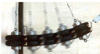
Prova del pendolo EN 12600
